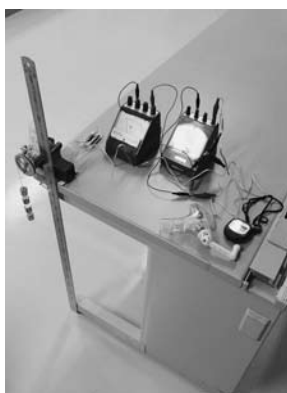
図4 手回し発電機による仕事を測定するための概要図(左図)及び測定器具の概観図(右図)
