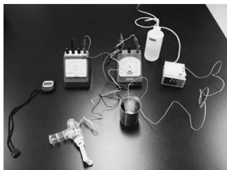
図 1 手回し発電機による水の温度上昇を測定するための概要図（左図）及び測定器具の概観図（右図）
