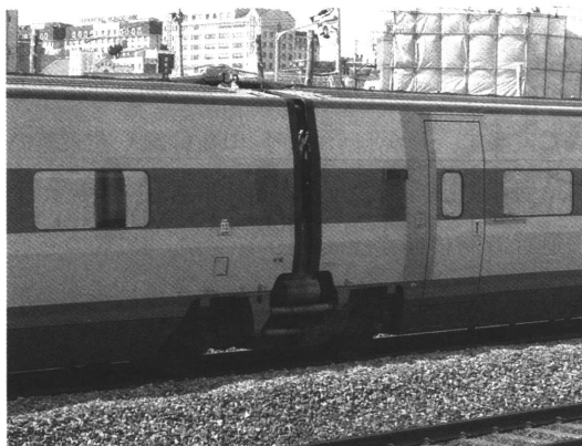
写真3-2-1 KTXの関節型台車
