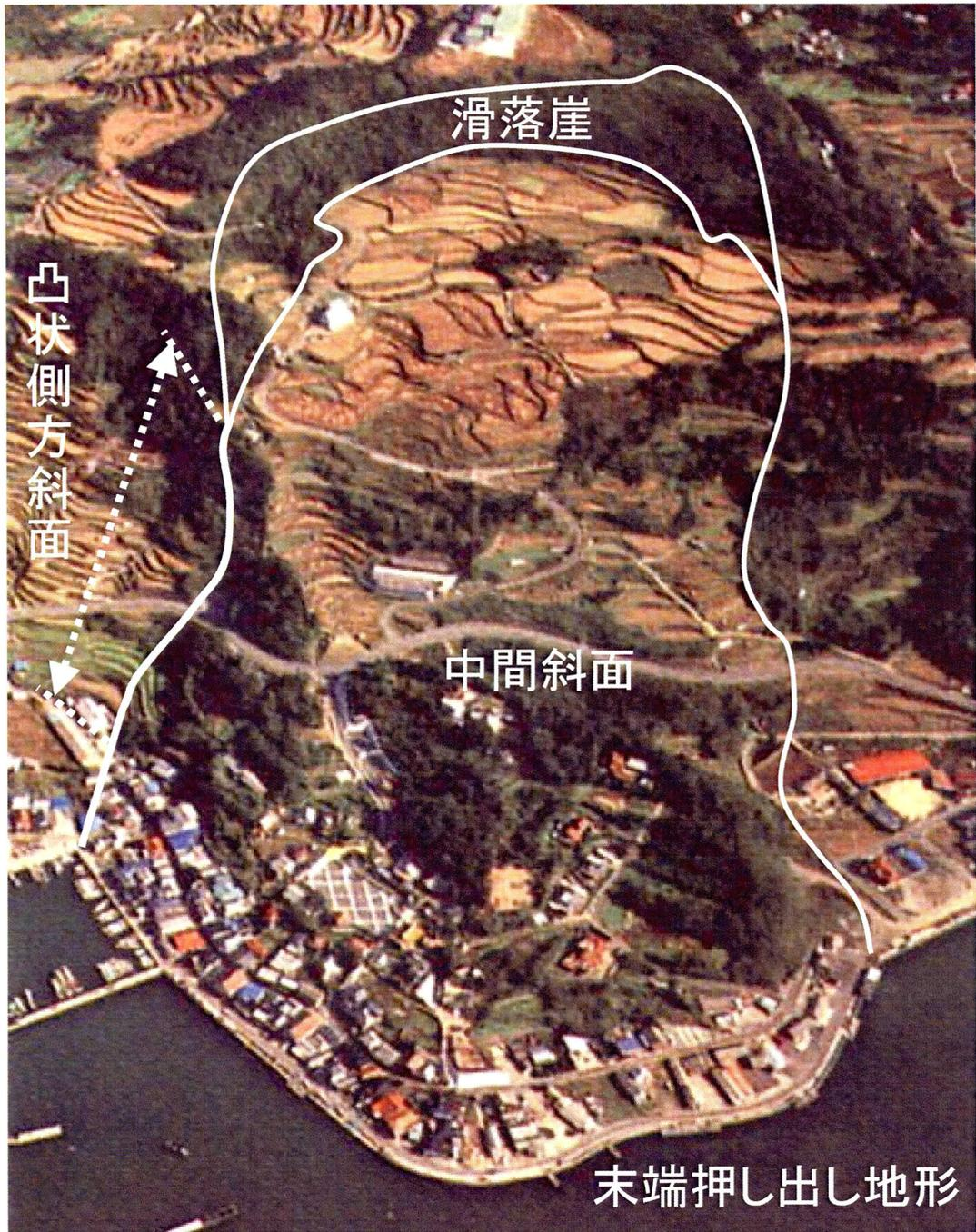
写真-4.1 斜め航空写真による地すべり地形の全景(久津地区)
