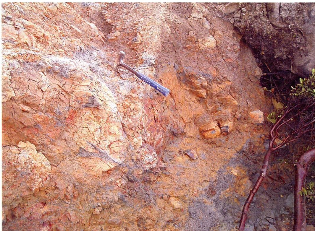
写真-4.7 末端押し出し地形における粘土質の崩積土（西山地区）
