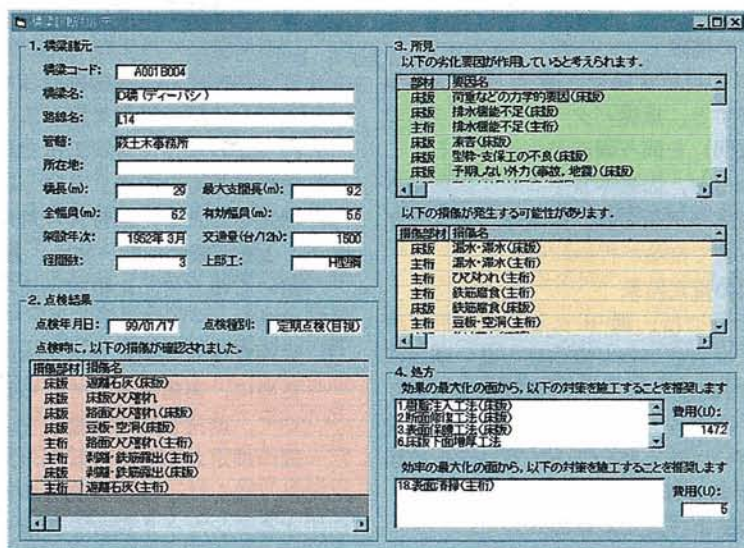
図-9 橋梁診断カルテ画面の例
