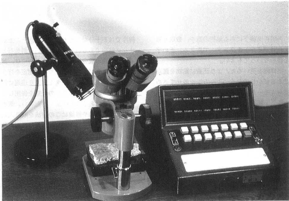
第2図 染色された花崗岩スラブのモード測定（実体鏡を使用） 右側はポイントカウンター
