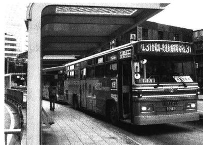
台北市中心部での市内バスで注目すべきは、民権東路などの一部の道路では南北方向に走る新交通システム(木柵線)と地下鉄(淡水線)を東西方向に連絡するように公車専用路(バス専用レーン)が道路の中央に設置され、バスがそこを走行するという中央走行方式(あるいは中央バスレーン方式)が採用されていることです。この方式は、わが国では名古屋市の基幹2号系統(出来町線)で採用されている方式で、韓国のソウルや中国の昆明などでも採用されています。また、中央走行方式はガイドウェイバス方式とよばれることもあります。
