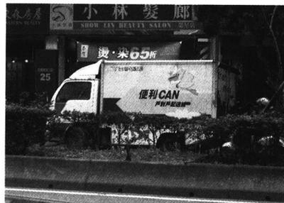
2000年10月にヤマト運輸がノウハウを提供した「統一速達(股)公司」が宅急便事業を開始しました。なお、外国資本投資規制によりヤマト運輸は出資できず、そのためノウハウの提供という形態になっています。集配に使用されている集配車はわが国で使われているクイックデリバリーとよばれるウォークスルータイプの車両ではなく、普通の有蓋車で、冷蔵冷凍庫を装備したものです。
