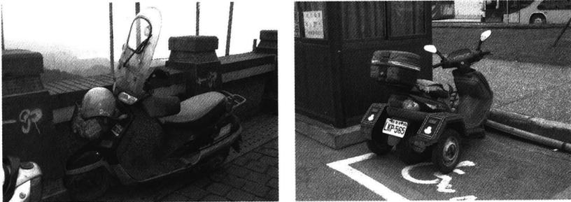
驚かされるもうひとつの形状は車輪が4つある四輪スクーターで、補助輪付きスクーターといった方が適切かもしれません。わが国で電動四輪スクーターといえば、高齢者によって買物や通院などで使われている車両を指していますが、このような形状のものではなく、ジャイロ キャノピーのようなものでもありません。後部車輪の左右に車輪をひとつずつつけ、それによって後部の車幅を広げたものです。
