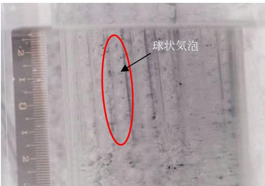
写真-2 気泡の状態 (空気流量8.20 /分)
