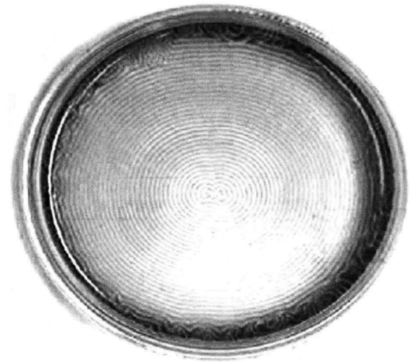
図1：ラセン対流波が発生したときの様子
